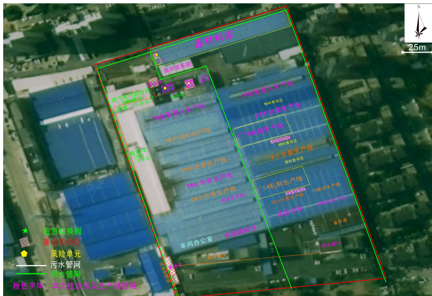
附图3 项目厂区平面布局图以及雨污管网图
