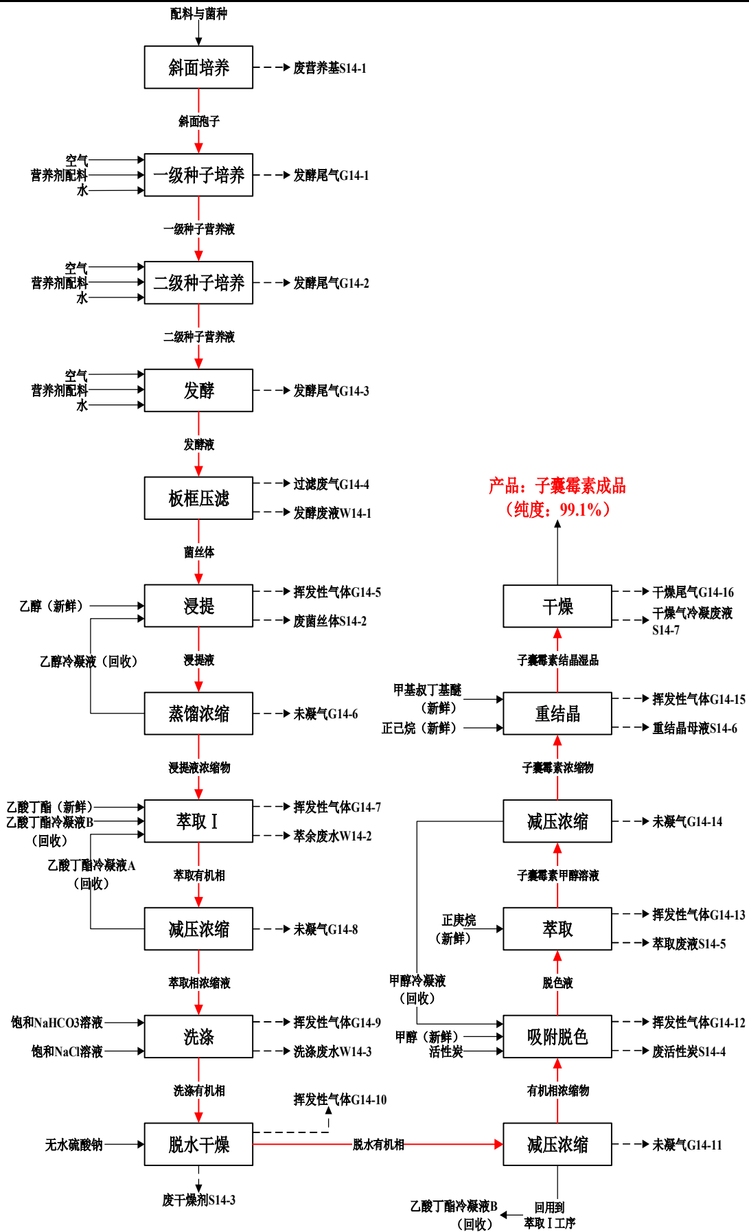
图 3-22 子囊霉素生产工艺流程及产污节点图
