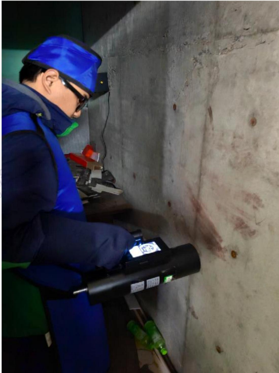
探伤室北侧暗室屏蔽墙外 30cm 处
