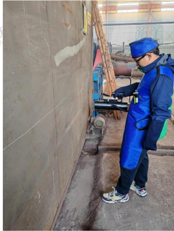
探伤室西侧防护门中间外 30cm 处
