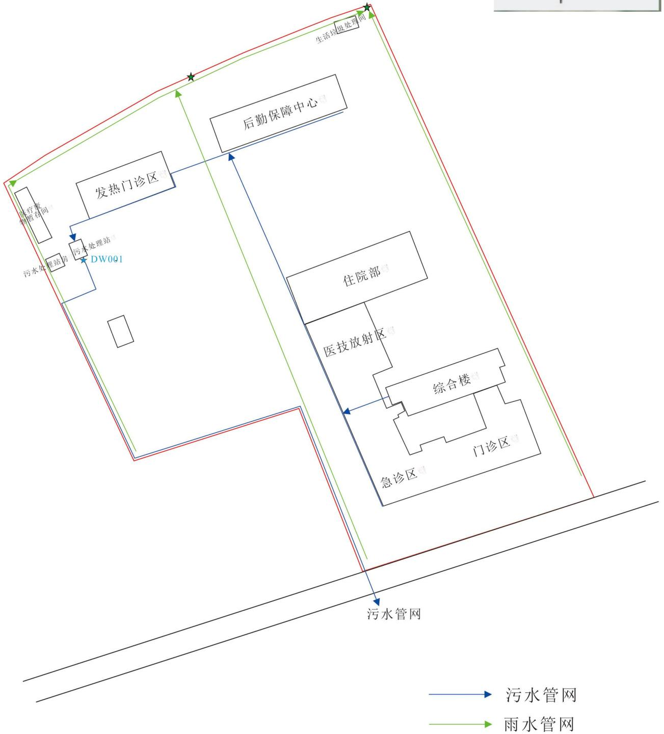
附图3 新院区总平面布置图(含雨污管网图)
