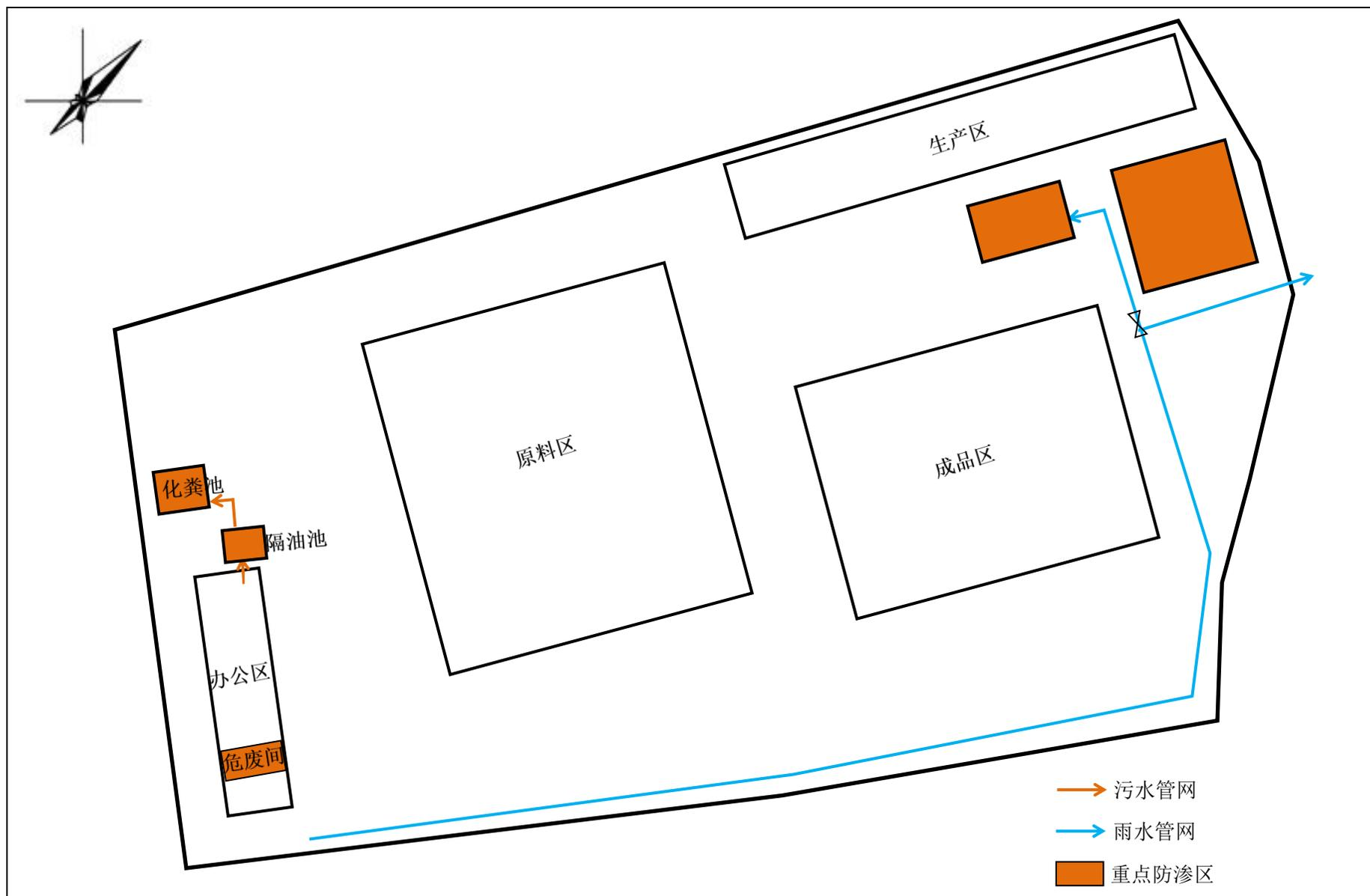
附图5 项目雨污管网图、分区防渗图
