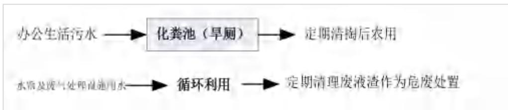
图 3-3 项目废水处理工艺流程图
