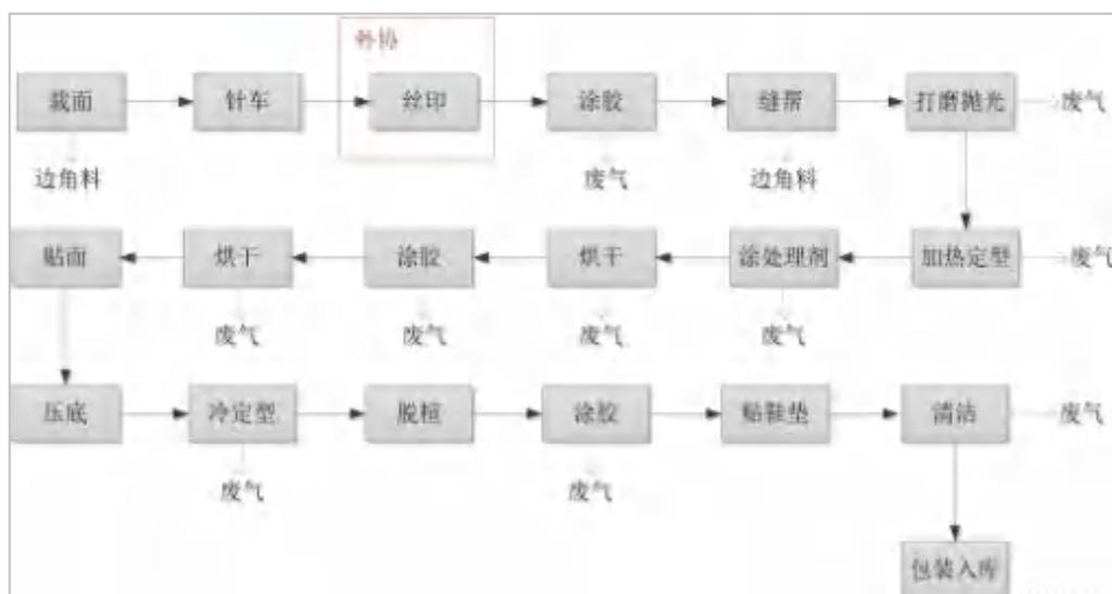
图 3-2 休闲鞋生产工艺流程及产污环节示意图
