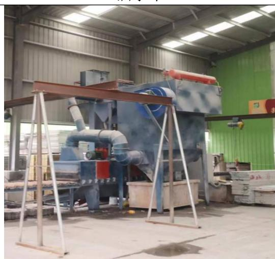
喷砂设备自带除尘装置
