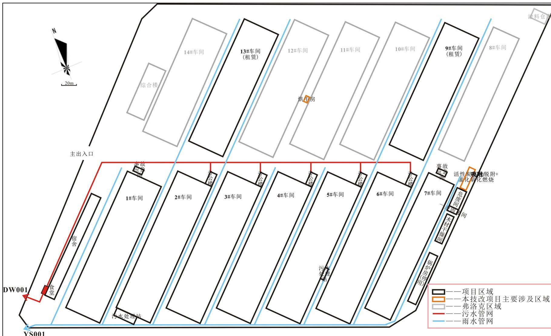
附图5 厂区雨污管网图
